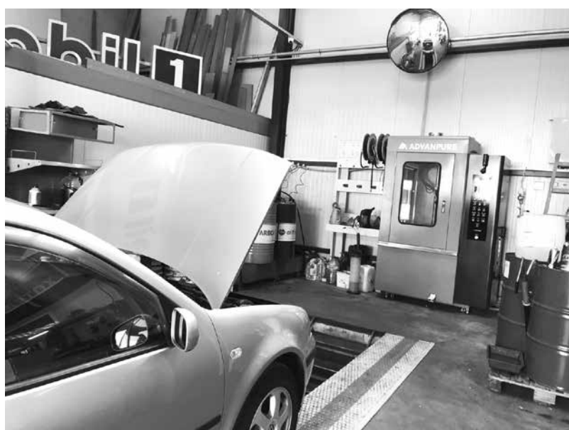
Автомобилът е на канала, замерват се отработените газове на изхода ФОТО: МОНИКА ИЛИЕВА
